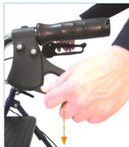
Als u tijdens het lopen met de rollator wilt remmen, trekt u beide remgrepen met de handen omhoog (zie afbeelding). Rem altijd langzaam en gelijkmatig met beide handen.
