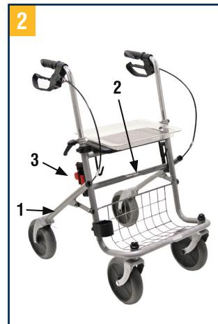
Placez le Rollator sur ses roues. En tirant sur l'un des tubes de la roue arrière, vous pouvez déplier le châssis (fig. 2 point 1). Ensuite poussez l'entretoise tout droit vers le bas (fig. 2 point 2) jusqu'à ce que cette dernière encliquette légèrement. Tournez la sécurité anti-pliage (fig. 2 point 3) jusqu'à la butée, de sorte que cette dernière soit verticale à l'entretoise.
