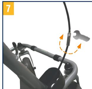
Lorsque l'effet de freinage est mauvais ou trop dur, on peut régler le frein, soit au boîtier de freinage en haut (fig. 1), soit à l'aide d'un outil approprié (pas compris dans la livraison) à la vis de réglage en bas au câble Bowden (fig. 2) sur l'effet de freinage désiré.
