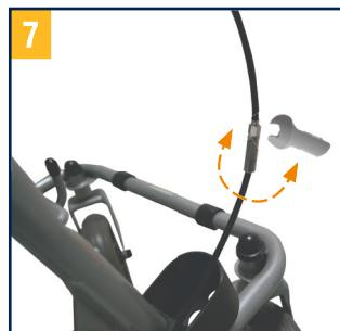
Bei schlechter oder zu harter Bremswirkung kann die Bremse entweder am Bremsgehäuse oben (Bild 6) oder mit entsprechendem Werkzeug (nicht in Lieferung enthalten) an der Einstellschraube am Bowdenzug unten (Bild 7) auf die gewünschte Bremswirkung eingestellt werden.
